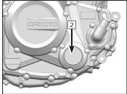
**Момент затяжки сливной пробки: 25 Н·м**
